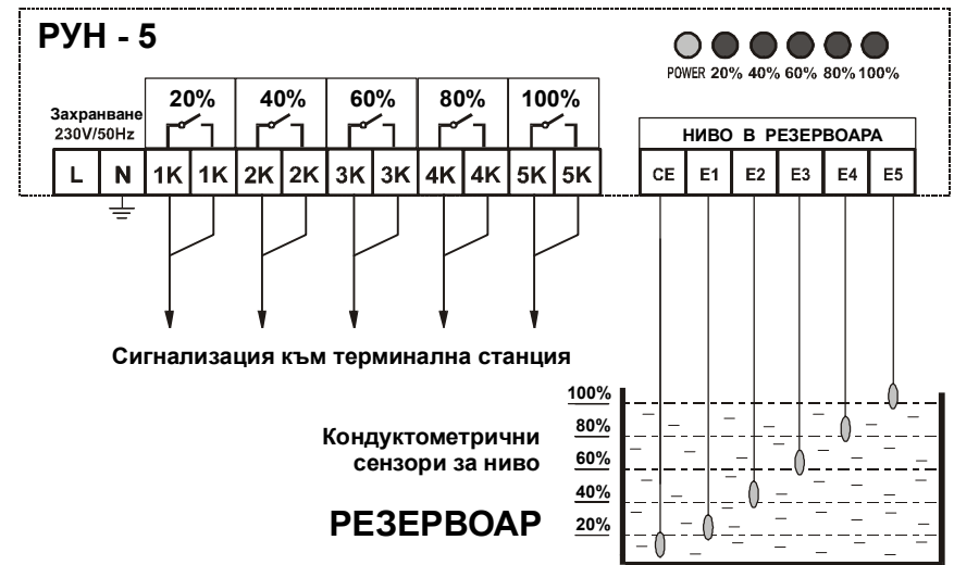
Фиг.1. Схема на присъединяване на РУН-5
