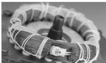
Фиг.3. Монтаж на "S01" в намотката
