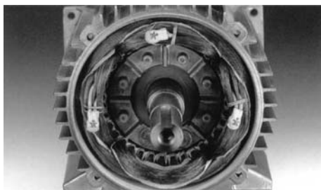
Фиг.2. Монтаж на "S01" в челните съединения
